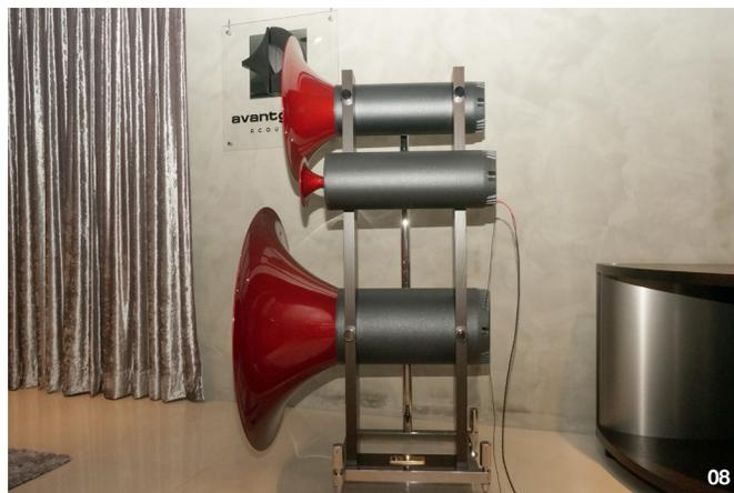
08. 從這個側面角度來看三個號角，可以發現高、中、中低音單體的發聲點幾乎是在同一垂直軸線上的。
