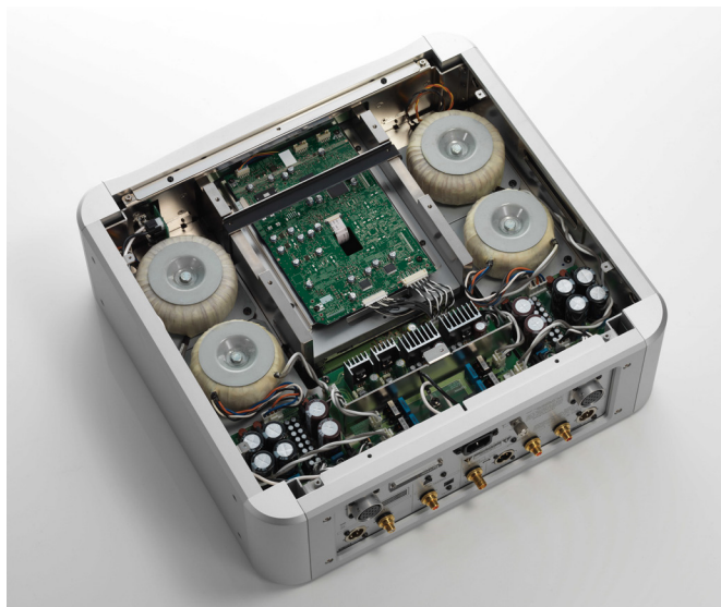
這是K1X的下層，也就是電源供應部分，清楚的看到四個環形變壓器，以及重重穩壓，還加上EDLC電雙層電容。
