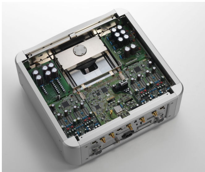
K1X的機箱分為上下二層，上層是線路板與讀取系統，圖中是上層。
