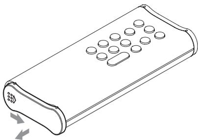
**2** 確認AA電池的⊕/⊖方向，如圖示裝入電池，再將電池座推入遙控器內。
