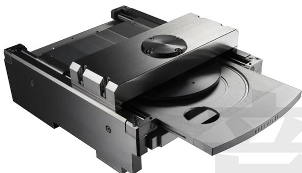
← 與VRDS-Neo相較，VRDS ATLAS的重心更低，馬達設置在下方，承盤圓柱軌道改為設置在承盤兩側。橋架上的轉軸以往設置在中心點，VRDS ATLAS將其前移，藉此打散共振干擾。
