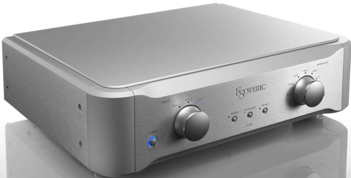
類型：唱頭放大器。推出時間：2017年6月。輸入端子：XLR×1（MC），單端RCA×2（MC/MM）。輸入阻抗匹配：MC：10、50、100、200、300、500、1k、10k歐姆；MM：47k歐姆。輸出端子：XLR/ES-LINK Analog（XLR）×1，單端（RCA）×1。輸出阻抗：XLR：20歐姆，RCA：23.5歐姆。輸入靈敏度（1kHz、固定輸出）：MM 20mV、MC 1mV。最大輸入電平（失真率0.1%）：MM 100mV、MC 4.8mV。訊噪比：MM 100dB、MC 80dB。聲道分離度（MM、10kHz）：-96dB以上。低頻軋聲濾除：17Hz，-6dB/Octave。消耗電力：23瓦。外觀尺寸（WHD）：445×131×377mm。重量：12.5公斤。參考售價：289,000元。進口總代理：勝旗（02-25974321）
