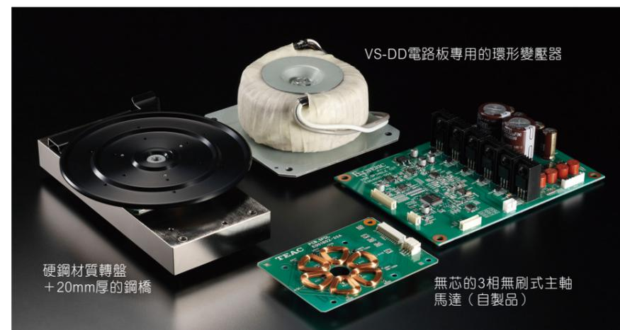
VS-DD電路板專用的環形變壓器
