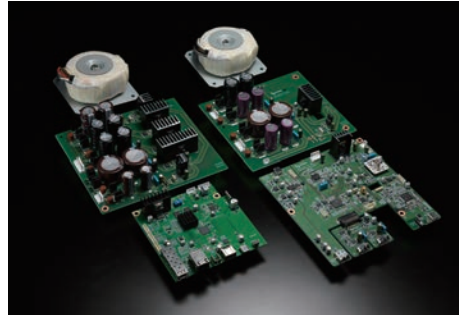
ESOTERIC Network Engine G4 (左前) 與數位音訊電路 (右前) 各自使用獨立的大型線性電源。
