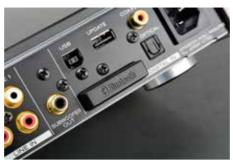
AI-301DA擁有相當多元的功能,從背面看 過去,就能看到在超低音訊號輸出端子旁 邊,有藍牙無線訊號模組,而且支援傳輸品質較 高的aptX編碼,能夠傳輸無損失壓縮訊號,讓無 線音樂也有更好的品質。
