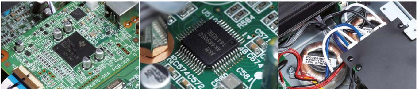
▲左：NT-503的網路接收模組有完整的Buffer，由一顆Toshiba生產的NAND搭配2顆EtronTech的DRAM組成。中、右：左右聲道各有獨立的環形變壓器跟各一顆AK4490，確保聲音純淨。
