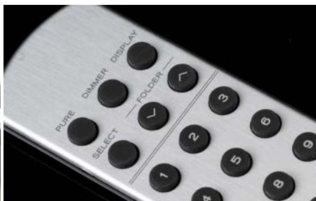
▲左：音訊電路由此EI變壓器獨立供電，上面外加一層黑色絕緣層，避免噪訊干擾。中：本機其它部位由此交換式電源供電。右：按下遙控器上的「Pure」鍵，開啟Pure Mode後，播放CD及WAV檔時數位輸出功能會關閉，播放DSD音檔時，音檔不會經過delta-sigma轉換與數位低通濾波器，保存聲音原味。
