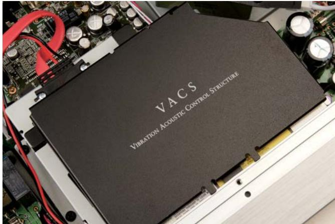
▲左：本機讀取機構採用VACS抑震架構，在光碟機外加上一層黑色金屬框架，減輕碟轉動產生的震動。右：音訊從光碟機讀取後，直接進入ESMT記憶體緩衝，減少Jitter的發生。此外，類比訊號輸出前裝載一枚SHINMEI RSB-12-S繼電器，當本機播放另一格式音檔時，會發揮保護電路的作用。
