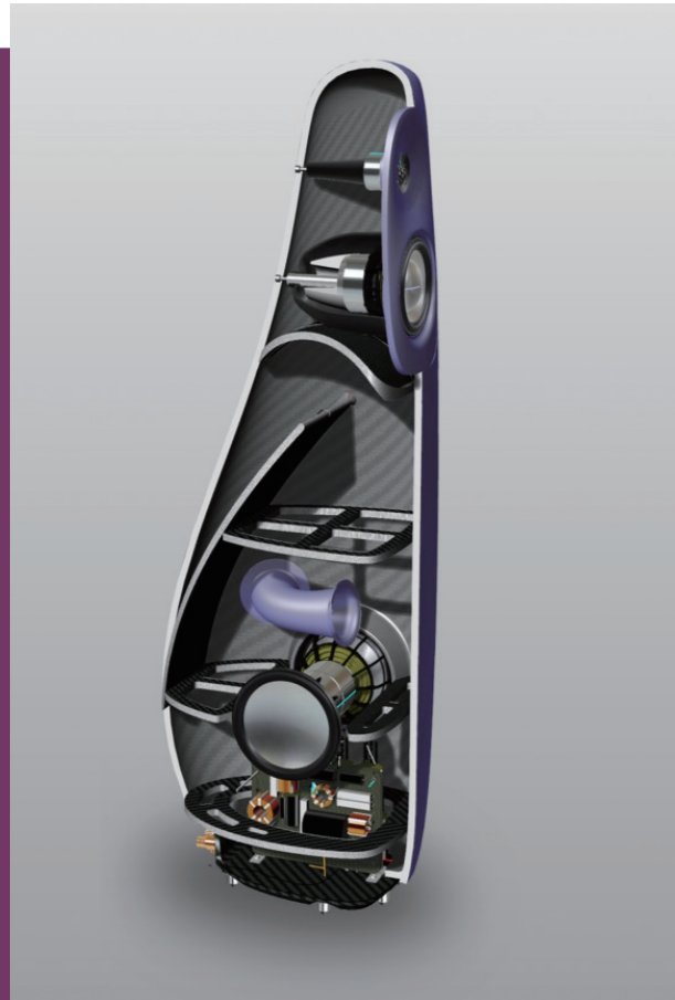
KAYA 45 的單體配置與箱體結構。導波管的設計可大幅減低箱體震動，背對背配置的雙低音單體為KAYA獨特的反相消除技術。
