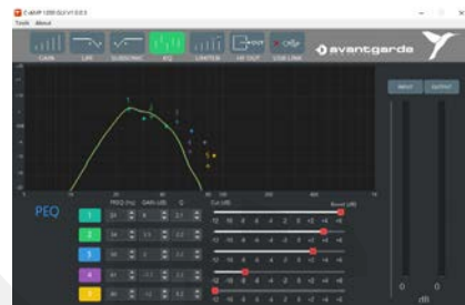
● 這是C-AMP1200超低音調校程式的其中一個介面，具備5段PEQ調校功能，可以進行更精細的調校設定，讓C18與C2更完美的銜接。
