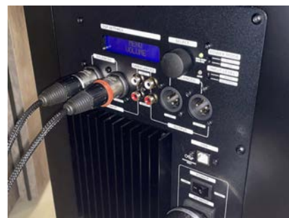
● C18的背板具備類比輸出與輸入端子，可以串連多顆C18同時使用。背板具備簡易的調整介面，不過原廠建議透過USB連接電腦，透過專屬的C-AMP1200超低音調校程式進行更精細的調校設定。
