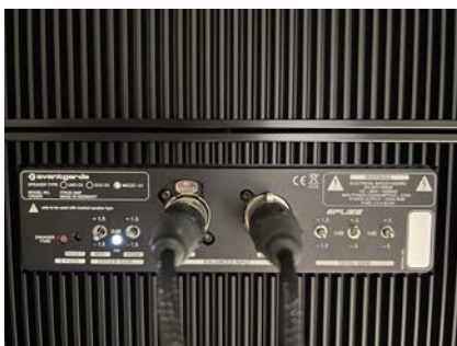
● 主動式的前級訊號輸入處，此外還有高音、中音的調整與整體增益的調整。
