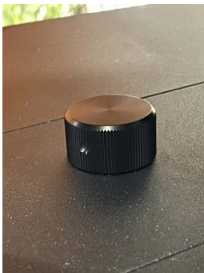
● 這是高音單體位置調整鈕，轉動時可以前後移動高音單體。
