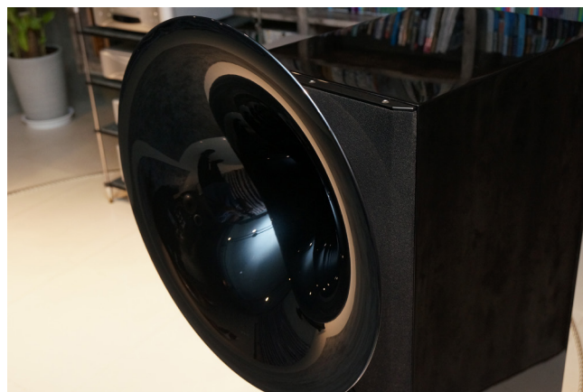
● 喇叭的中音單體具備號角設計，採用127mm振膜，材質為兼具阻尼特性與高剛性的Soft Mesh Compound，發聲效率達到107dB。外側號角為500mm，以ABS壓鑄成型，不易變形，材質均勻，共振能量低。
