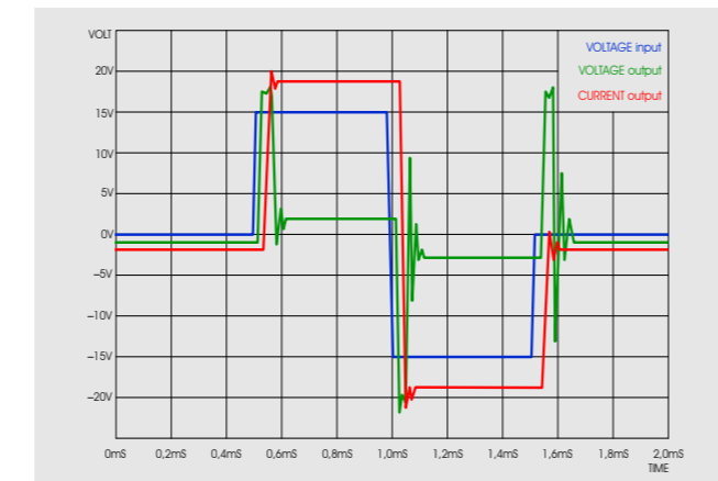
圖2：模擬iTRON 電流放大
