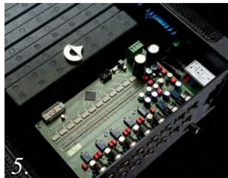
▲圖1. XA-PRE/XA-POWER不只把手附有抗滑顆粒，XA-PRE那颗超大型音控旋鈕上也有同樣菱格紋路設計，甚至連它的遙控器也是如法炮製。 圖2. XA-POWER以兩對功率晶濾波作傳統AB類推挽架構的放大級，8顆10000 \mu F大容量電容能確保每聲道輸出150瓦的線性供電能力。 圖3. XA-POWER在電源處理電路上可見左右聲道各自獨立配置各四顆Mundorf M-lytic AG 10000 \mu F的低壓濾波電容，與各兩顆大型電感。 圖4. 三顆藍色外殼的電源變壓器作整流穩壓之用，分別供電給左右聲道之輸出、輸入電路板與開關控制電路使用。 圖5. XA-PRE每聲道以12顆Vishay TCMT4100光耦合器與許多SMT元件組成音控模組與「DC Flow Circuit」單端純A類電路，實踐最短路徑、最高解析與最大動態的設計理念。
