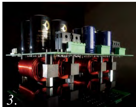
▲圖1. XA-PRE/XA-POWER不只把手附有抗滑顆粒，XA-PRE那颗超大型音控旋鈕上也有同樣菱格紋路設計，甚至連它的遙控器也是如法炮製。 圖2. XA-POWER以兩對功率晶濾波作傳統AB類推挽架構的放大級，8顆10000 \mu F大容量電容能確保每聲道輸出150瓦的線性供電能力。 圖3. XA-POWER在電源處理電路上可見左右聲道各自獨立配置各四顆Mundorf M-lytic AG 10000 \mu F的低壓濾波電容，與各兩顆大型電感。 圖4. 三顆藍色外殼的電源變壓器作整流穩壓之用，分別供電給左右聲道之輸出、輸入電路板與開關控制電路使用。 圖5. XA-PRE每聲道以12顆Vishay TCMT4100光耦合器與許多SMT元件組成音控模組與「DC Flow Circuit」單端純A類電路，實踐最短路徑、最高解析與最大動態的設計理念。
