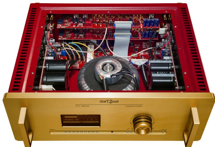
CTH-8550 MKII的內部最顯眼的就是環形變壓器，而且是上下二個一大一小。這二個環形變壓器內部都是二組繞組，分別供應左、右聲道。下面那個大的供應功率輸出級，上面那個小的負責前級線路，以及各項操控顯示線路所需電源。
