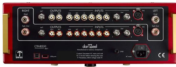
CTH-8550 MKII的背板左右聲道輸入端分上下二排，XLR輸入端子只有一個，RCA輸入端子有六個，其中一個給MC唱頭輸入，一個給MM唱頭輸入。而他家特有的50歐姆BNC端子則有二個。輸出端則只有一個前級輸出與一個REC，此外還有一個50歐姆BNC輸出。
