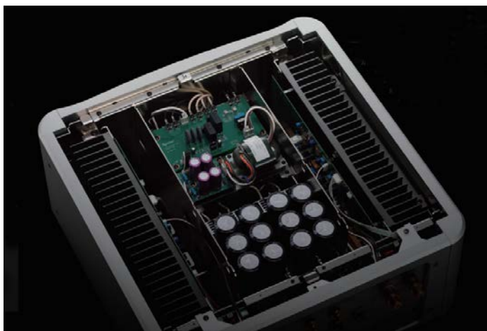
● S1X的內部，從上看看不到環形變壓器，但可以看到其濾波電容分為好幾區，因為從整流開始就分左右聲道，電壓放大級與功率輸出級的濾波電容也不同。
