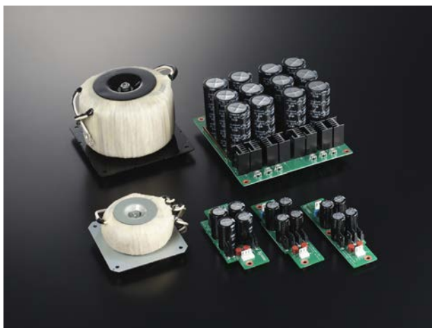
● S1X的功率輸出級，S1X的電源變壓器與濾波電容，大的變壓器給功率輸出級使用，小的變壓器給電壓放大級使用。濾波電容也分功率級與電壓放大級使用。
