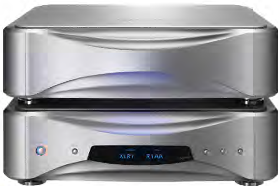
● Grandioso E1採用二箱式設計，面板上有顯示窗的是電源箱，負責電源供應；面板沒有任何東西的是主機箱，負責訊號放大。
