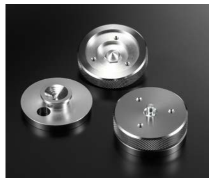
● F-01的腳座採用他家研發的Pinpoint Foot，表面上摸起來好像搖搖晃晃不牢靠，其實是藉著機體重量往下壓，達到一點接觸的目的，發揮避振效果。
