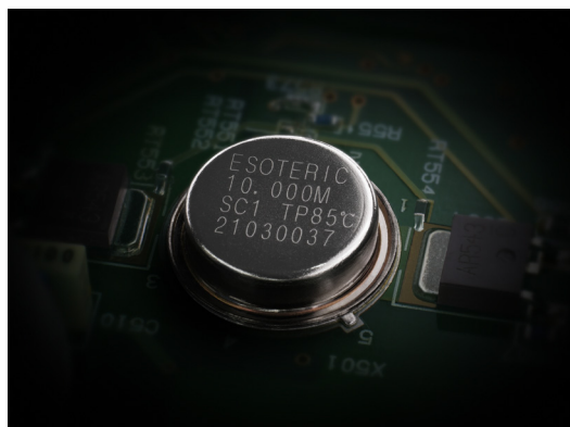
這就是Esoteric特別訂製的SC1石英振盪器，外殼上印有Esoteric品牌與SC1型號。
