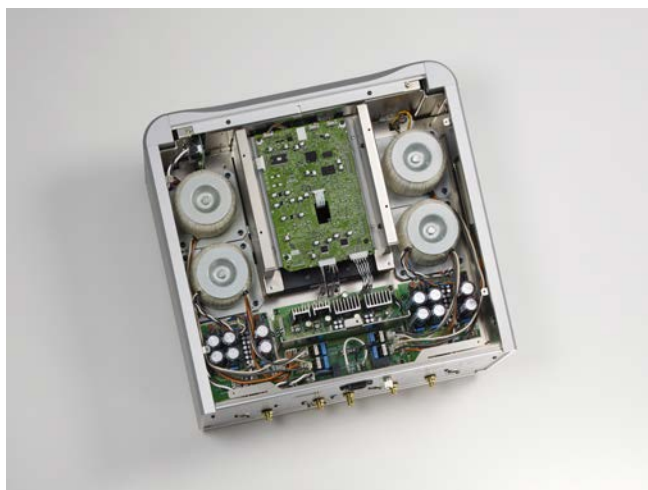
● K-01XD SE的下層，可以看到四個環形變壓器，以及滿滿的電源供應線路。
