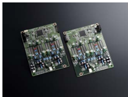
● 這是K-01XD SE的Master Sound Discrete DAC分砌式線路板。
