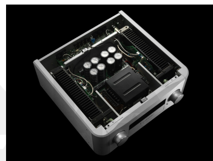
●F-01本身內建的電源配置就非常講究了，包括內部以一顆大尺寸的940VA EI電源變壓器做供電源頭，再以獨立繞組為機內的前級與後級做個別供電。內中共用上總數達80,000uF濾波電容，其中有18,800uF是獨立供電給前級使用。
