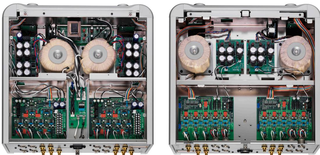
06. C-02X的內部可以看到用2mm厚金屬板隔開電源與線路，上層是輸入層，可以看到二個環形變壓器，下層是輸出層，有二個環形變壓器與一個EI變壓器。全機輸入輸出皆有緩衝級，而且是平衡架構緩衝級。
