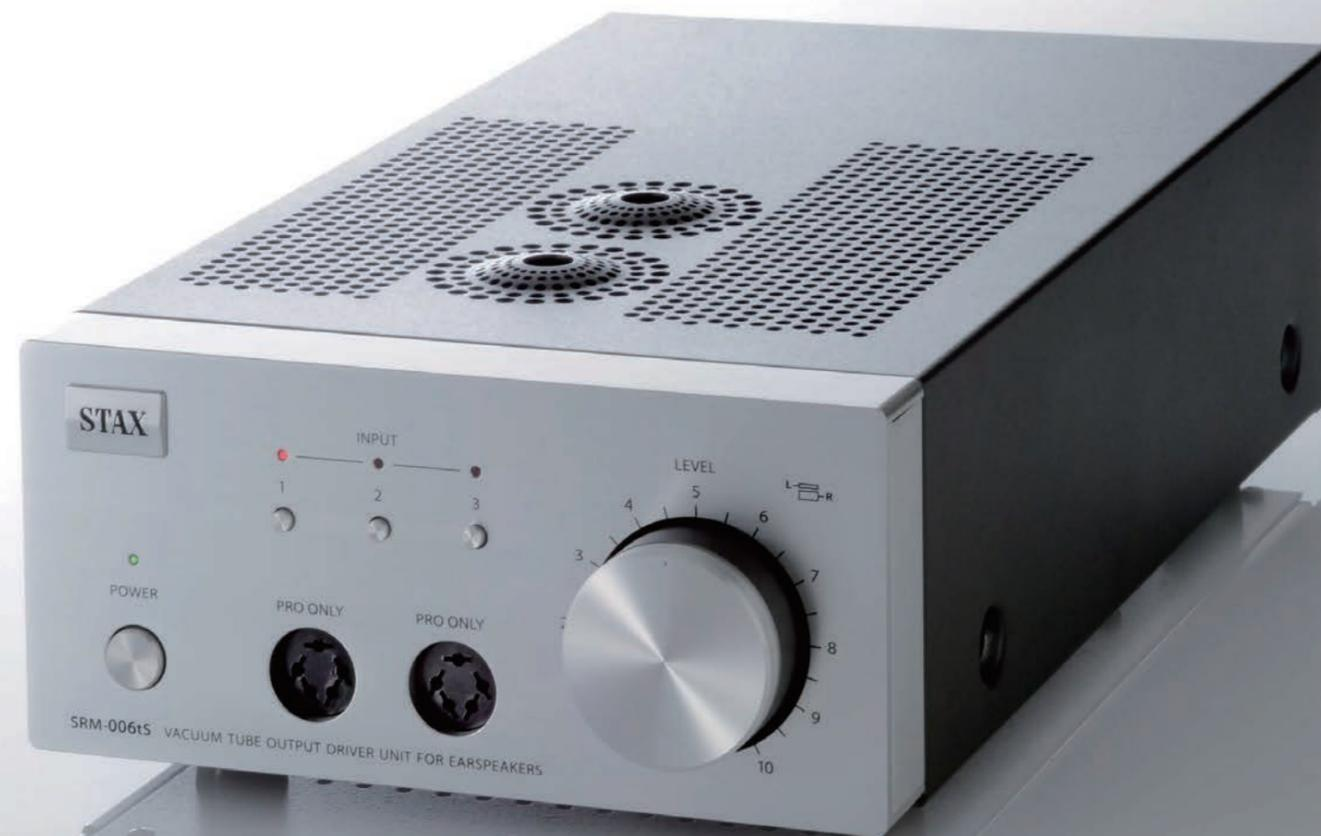
解析度密度的增加意味著頻率範圍的擴展 - 換句話說聲音的迴轉率提升了，因此需要重新檢視所有的響應特性如主動與被動元件，還有確保至極高頻都能穩定操作的電路。器材本身需要更低的失真與無盡高速的特性，同時運作狀況必需明確。真空管在這個目的上具備了高速電氣傳輸的優點，因此在本機輸出級採用了6FQ7(6CG7)雙三極管。燈絲電源規劃了超高速整流與低雜訊低損失的蕭基二極體以及大容量電解電容，低漣波的直流電源供應器提升了訊號/雜音比。另一方面，輸入級的平衡輸入使用訂製的同軸四聯音量控制器直接連結第一級的低雜訊FET，正確的電路與嚴選的元件帶來有力的低頻與完全透明的音質。平衡輸入的腳位為1 = shield，2=hot，3=cold。
