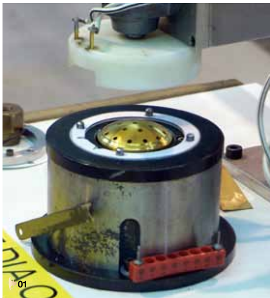
01/ 這是什麼東西？這就是Tannoy最貴的高音單體，那個大大的鐵塊上面還吸著一根鐵，那就是Alnico磁鐵。放在磁鐵裡面、露出金黃孔狀的東西就是壓縮式高音單體的底部。右為1947年Dual Concentric的原型。
