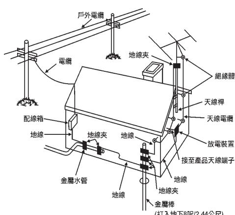
根據"國家電氣規程"的地線接地圖例
