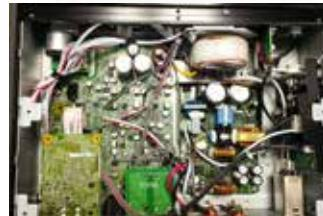
▲機內電路布局紮實，ICE power與環型變壓器分開供電，能夠獲得更高的音質純淨度。
