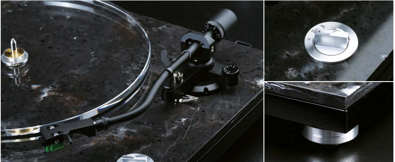
▲本盤的軸心結構類似直接驅動唱盤，可旋轉的軸心固定在唱盤底座上，搭配透明壓克力轉盤，除了隨盤附帶的毛氈唱片墊之外，廠方也有「和紙」唱墊提供選購。唱臂的軸承結構與TN-300類似，S型的唱臂臂管設計能有效打散臂管的諧振情形，唱盤的轉速直接由選擇開關切換即可。支撐唱盤的四個腳座，除了有避震效果之外，也具備高度調整的機能。
