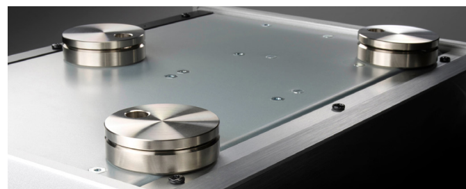
↑ UD-505與CG-10M的腳座均有考究，可以看到腳座底盤與腳釘是分開的，不過機器拿起後它們仍然是「合在一起」，因為兩者之間有螺絲固定，當放下後，底盤會往下掉，兩者間會有最小接觸面積。
