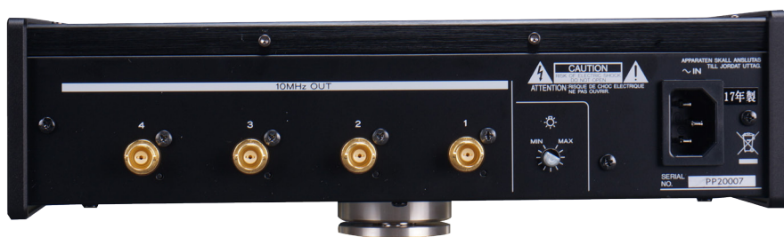
← CG-10M背板相對簡單，配備四組獨立的10MHz時脈訊號輸出，採用的是鍍金BNC端子。
