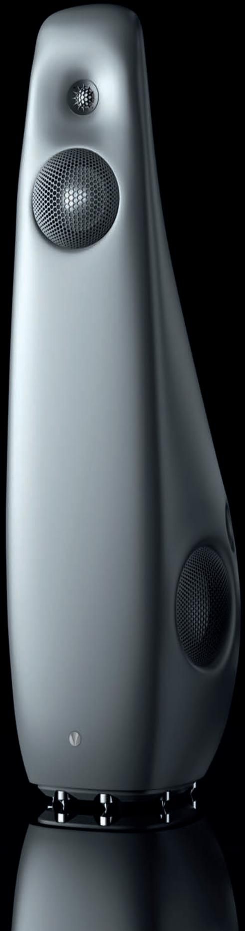
具備專利導管負載反射的反作用抵消單體裝置在複合材質音箱中，提供令人驚異但極為緊實的低頻，中音由我們新的C100ES單體負責，環狀的磁石就設在音圈的旁邊提供了更高的頻率響應並減低失真。單體裝置在其獨立的指數背波吸收號角之上，並將號角在其後方捲折，我們減少了40%的長度以適應袖珍型的音箱，但性能依然毫無妥協。最高頻段是我們信賴的D26高音單體，以碳纖維強化的懸垂線凸盆能維持活塞運動至40kHz，具備無比的清晰度與精確性。
