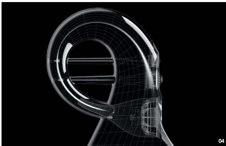
04. 從這張透視圖可以看到高音、中音與中低音單體後方消音管的構造。
