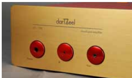
左圖 面板上只看到一個頗大的顯示窗，竟沒有旋鈕或按鈕。原來顯示窗是觸控面板，除了透過遙控器之外，必須透過按壓顯示窗來操控。 中圖 這三個紅色圓片都「不是」按鈕，由左至右分別是耳機輸出、紅外線接收孔與3.5mm輸入，跟一般器材大不相同。 右圖 本機背後還有一個Type A的USB，它不是用來連接電腦，而是用來插入「鑰匙」。如果沒有插入原廠附的這根隨身碟，機器無法啟動喔！
